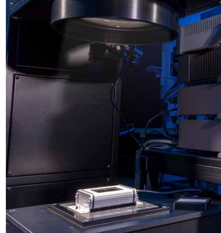
Kalibrierte Messung der Bestrahlungsstärkeempfindlichkeit s eines Strahlungssensors als Funktion der Temperatur T
